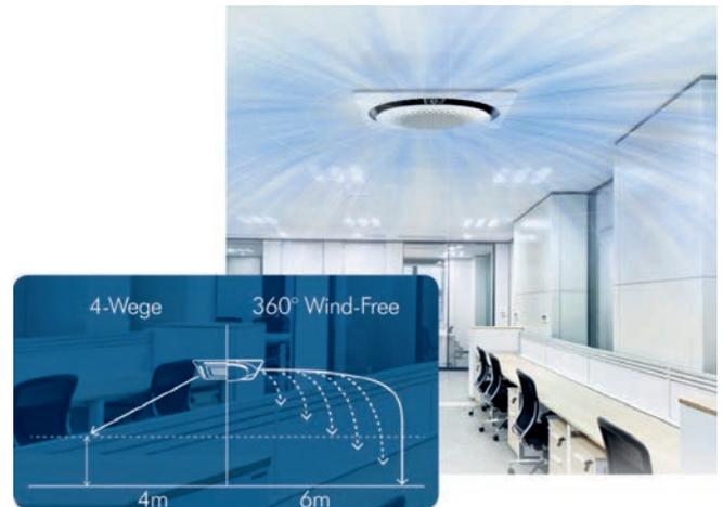
Mit den Wind-Free™ 360° Kassetten verteilt sich die konditionierte Luft leise in einer Luftgeschwindigkeit von nur 0.15m/Sekunde. Das garantiert eine zugfreie Raumlufzirkulation ohne das Gefühl, einen Kaltluftzug zu empfinden.
